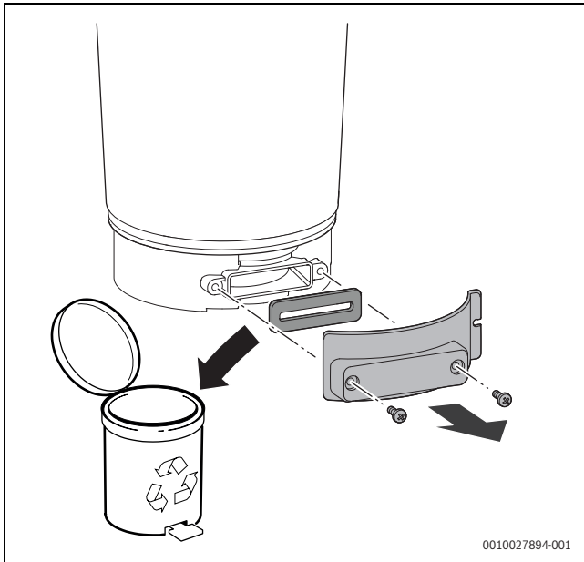
Obr. 64 Otvorenie revízneho otvoru
